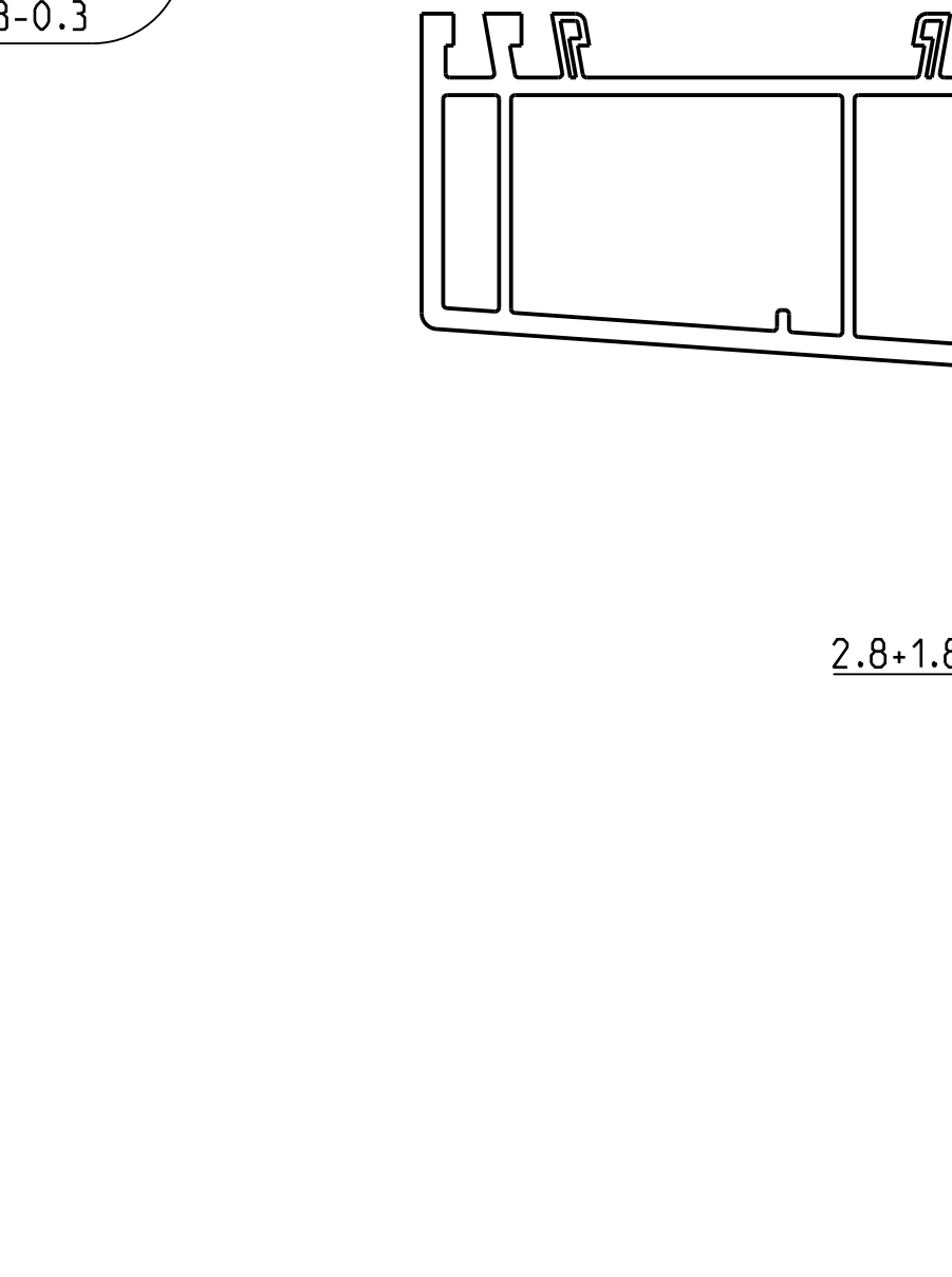
A-A verriegelte Fluegelposition / locked sash position
